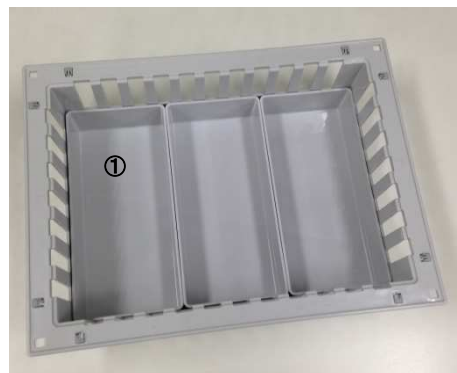
トレイインサート ①TI-211 ¥**** 外寸法/W242×D115×H51mm 内寸法/W220×D94×H49mm 材質/ABS(持続性帯電防止)
