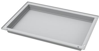
トレイ 64・05タイプ TRY-645 ¥8,360 価格改定 外寸法/W600×D400×H55mm 内寸法/W538×D338×H52mm 材質/ABS(持続性帯電防止) 搭載加重 10kg
