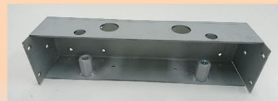
独自開発のアジャスターベース SECC t2.3 前後 二か所に取り付け
