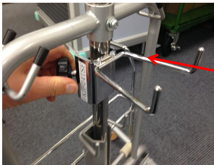
低圧持続吸引器プレート取り付けフックを取り付け
